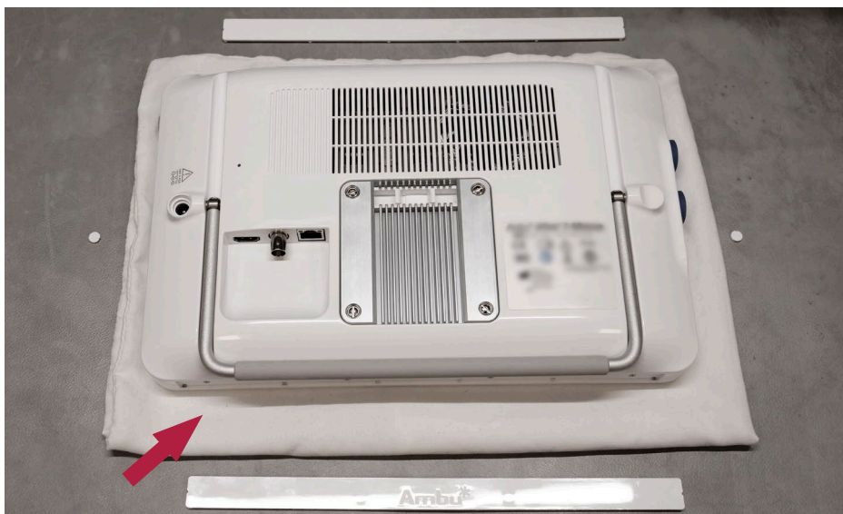
図8 ディスプレイ装置を下向きに配置
