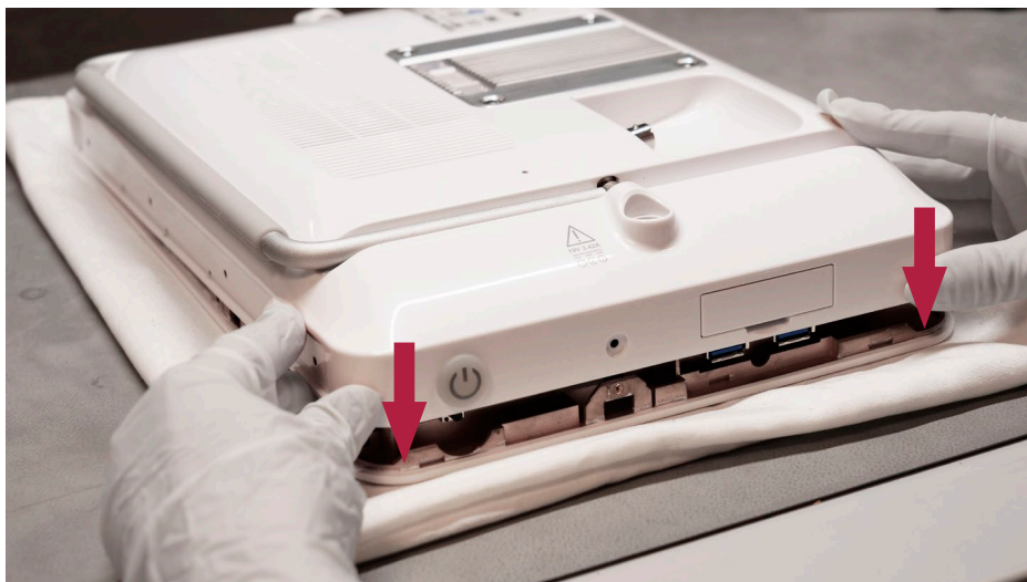
Figura 31 Posizionamento dell'alloggiamento posteriore, continuazione
