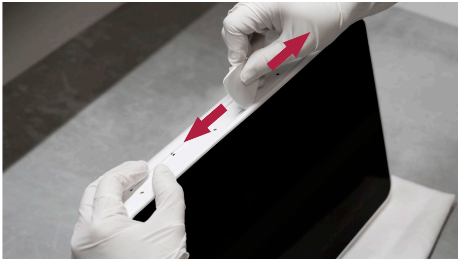
Afbeelding 7 De achterbehuizing met behulp van het plectrumgereedschap losmaken
