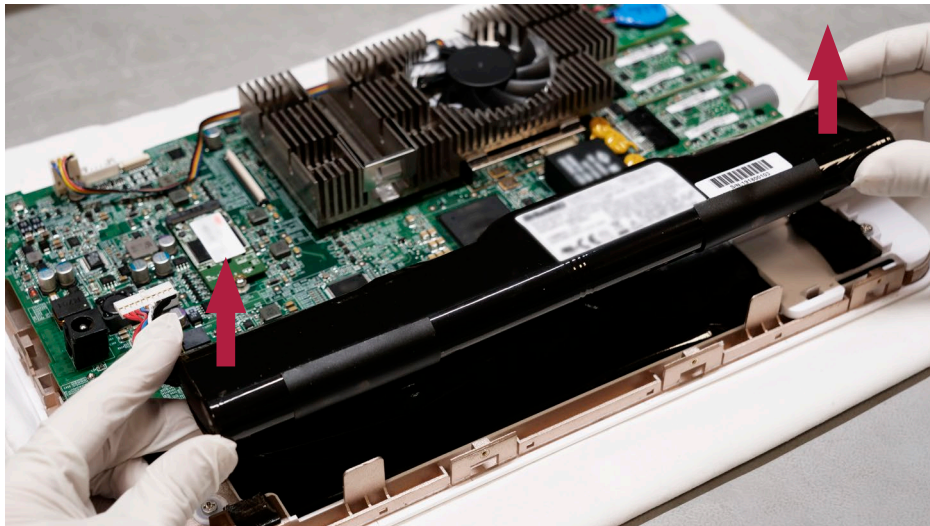
Bild 14 Ta bort batteriet
