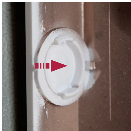
Figur 22 Monter dekselet hvis VDI-kortet av noen grunn er fjernet
