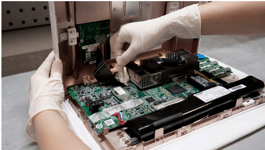
Figura 10 Abra la carcasa trasera con cuidado y retire la cinta adhesiva si fuera necesario
