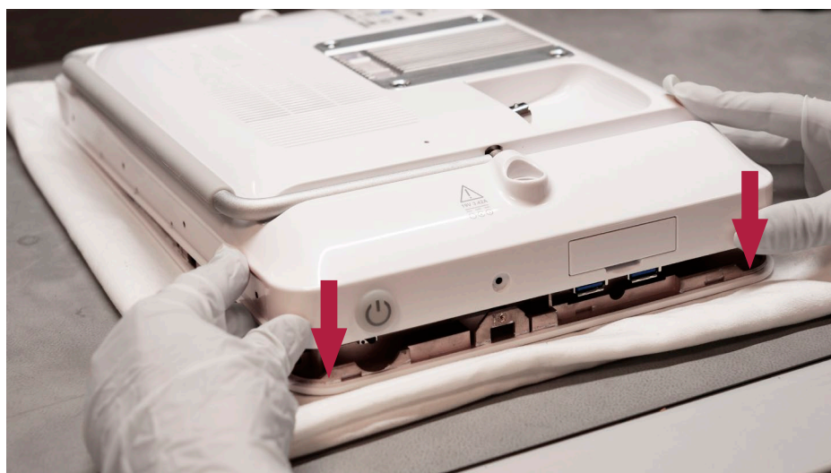
Figura 31 Colocación de la carcasa trasera (continuación)
