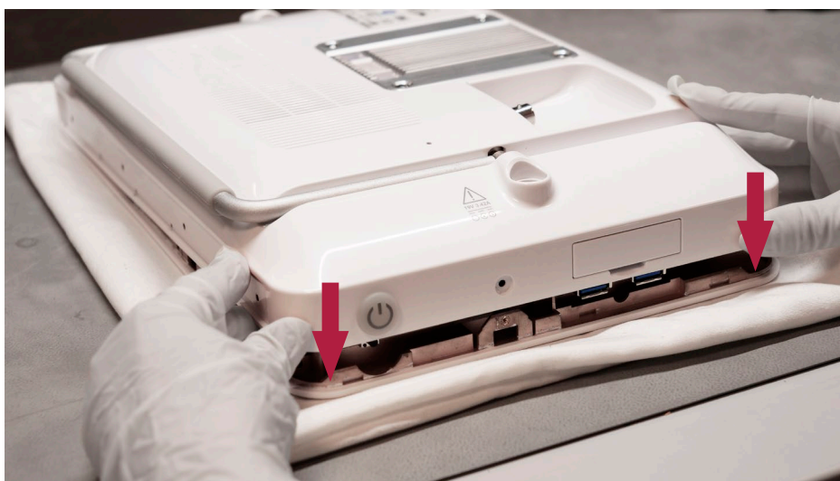
Kuva 31 Takakotelon laittaminen paikalleen, jatkuu
