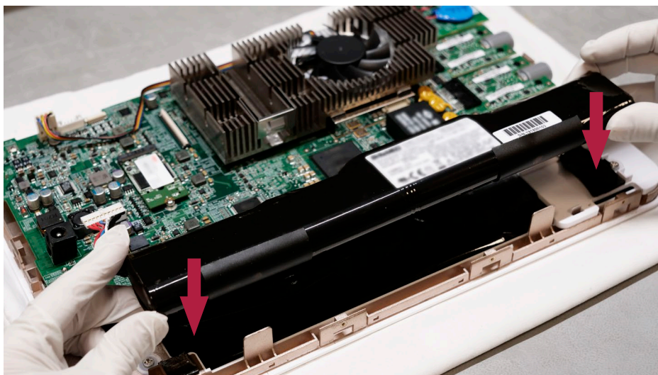
Joonis 15. Asetage uus aku oma kohale nii, et kleeplint on suunaga allapoole
