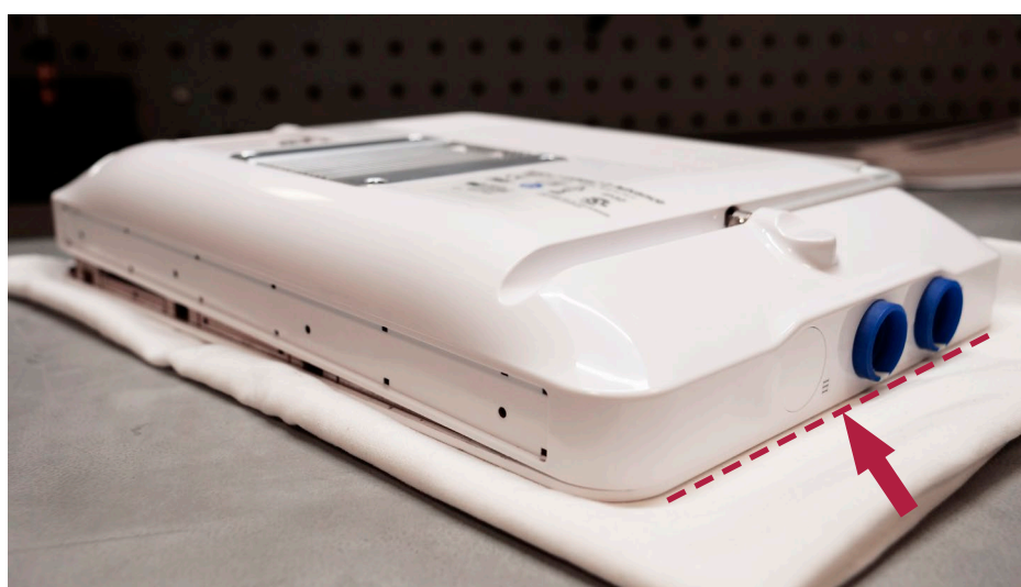
Figur 30 Sett på bakdekselet, begynn med siden der fargeringene sitter
