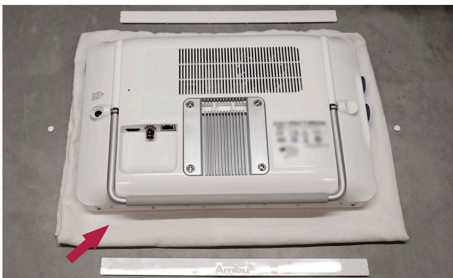
Rysunek 8 Umieszczanie wyświetlacza ekranem do dołu
