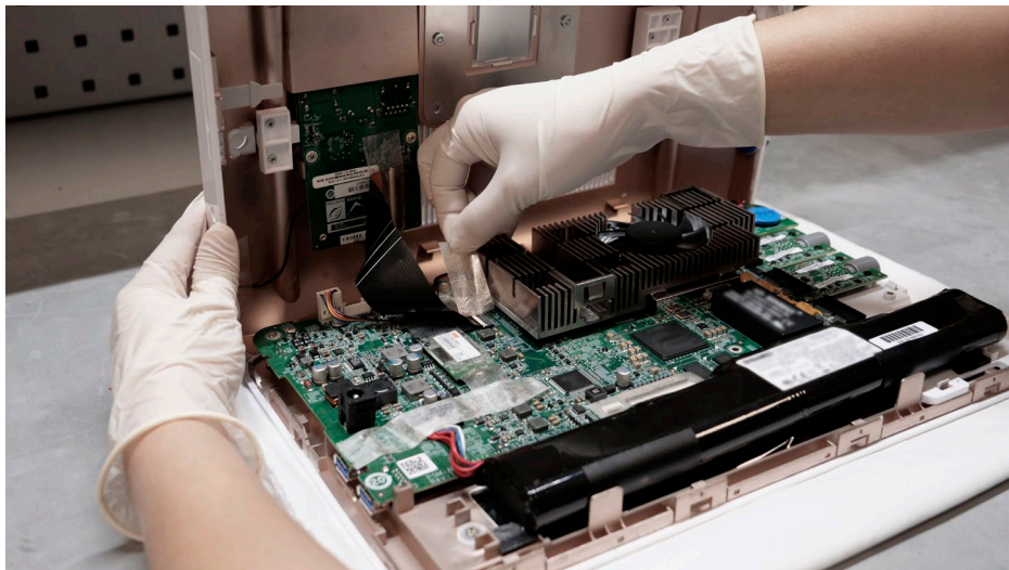
Abbildung 10 Die rückseitige Verkleidung wird vorsichtig geöffnet und das Klebeband gegebenenfalls entfernt
