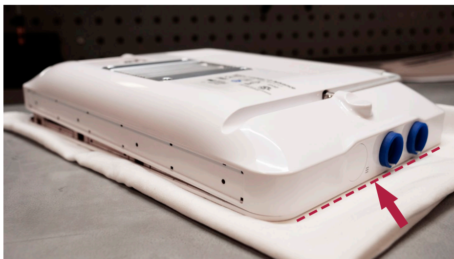
Illustration 30 : Positionnement du boîtier arrière, en commençant par le côté où se trouvent les anneaux de couleur
