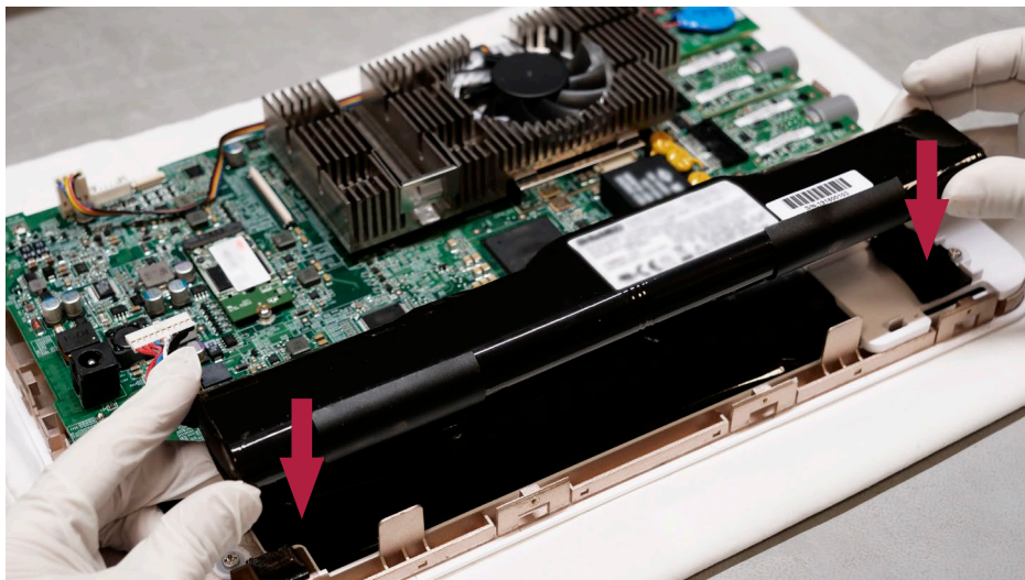
Figura 15 Posizionare una nuova batteria con il nastro adesivo rivolto verso il basso
