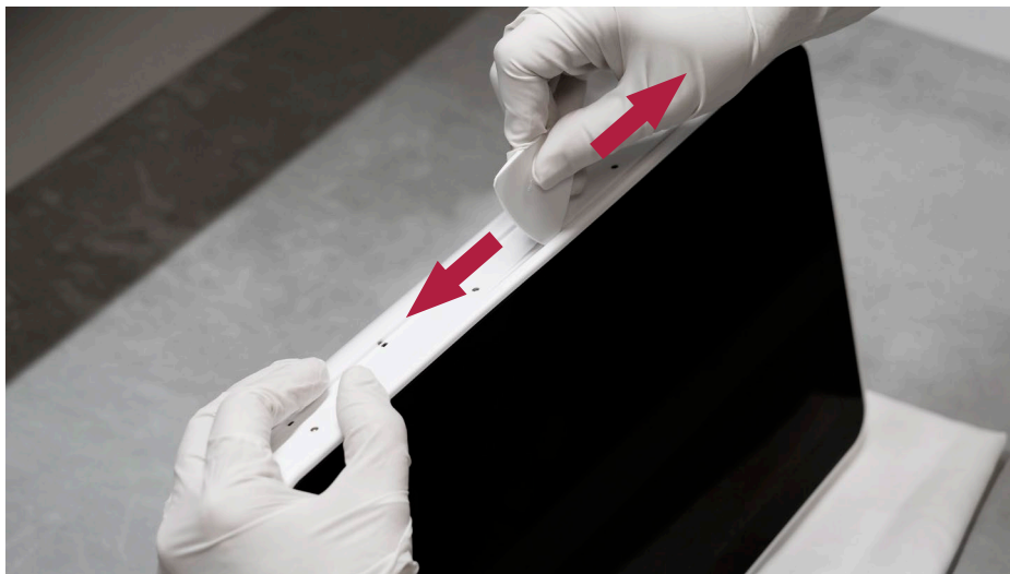
Rysunek 7 Zwalnianie tylnej obudowy przy użyciu plektronu
