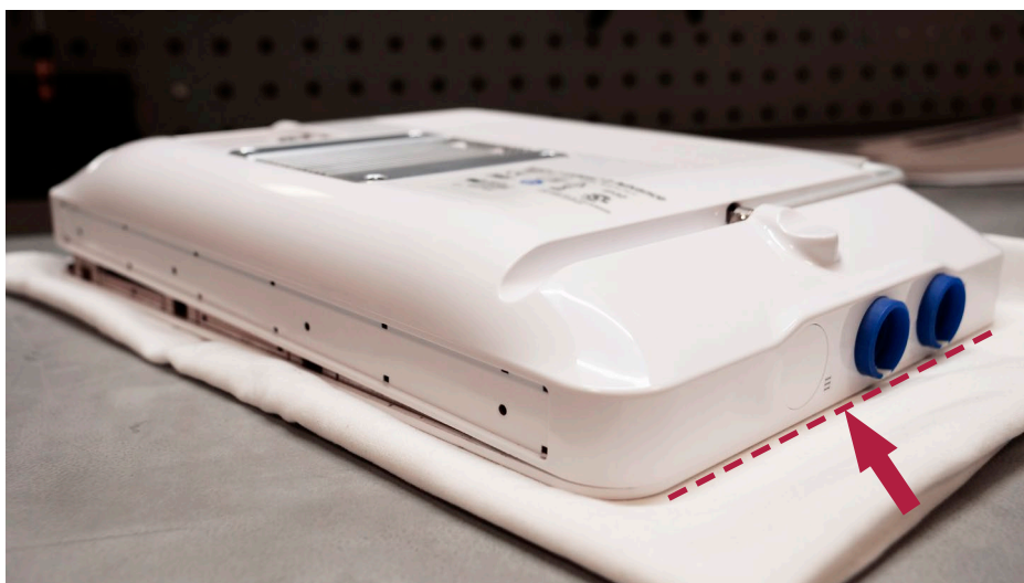
Figura 30 Posizionare l'alloggiamento posteriore partendo dal lato con gli anelli colorati
