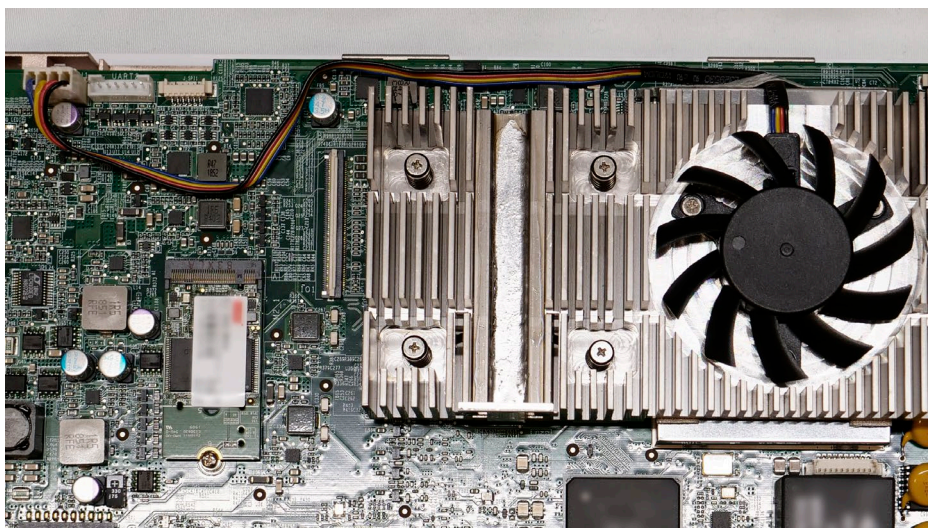
25. ábra: Szerelje be a ventilátort
