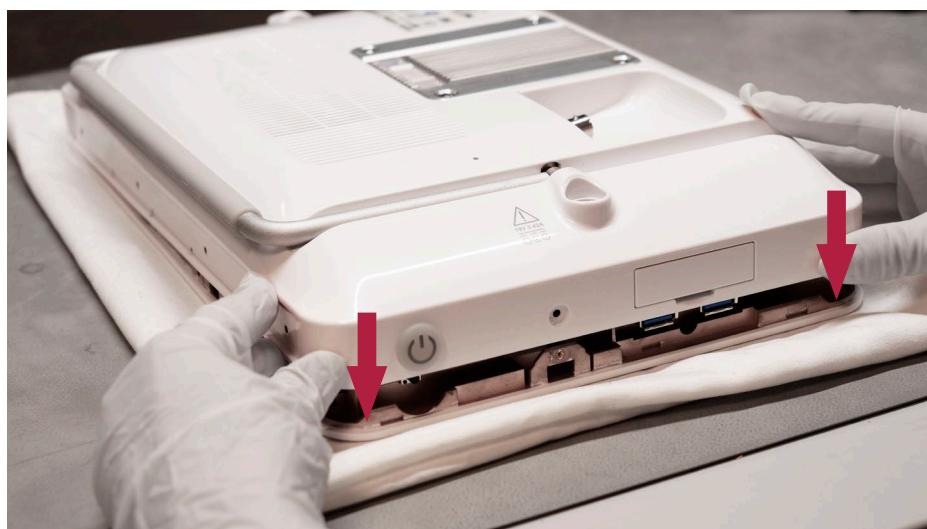
Bild 31 Sätta tillbaka höljets baksida, forts.
