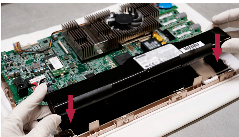
Рис. 15. Установка новой батареи клейкой стороной ленты вниз
