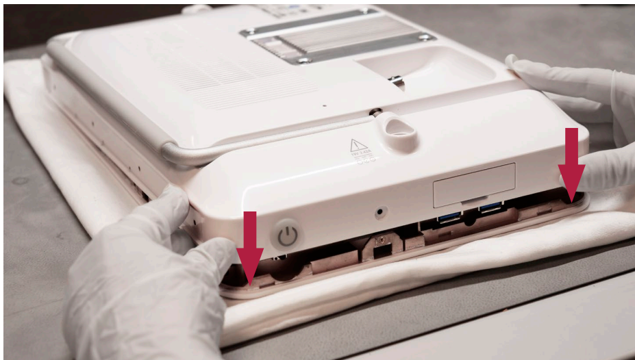
Фигура 31 Поставяне на задната част на корпуса, продължение
