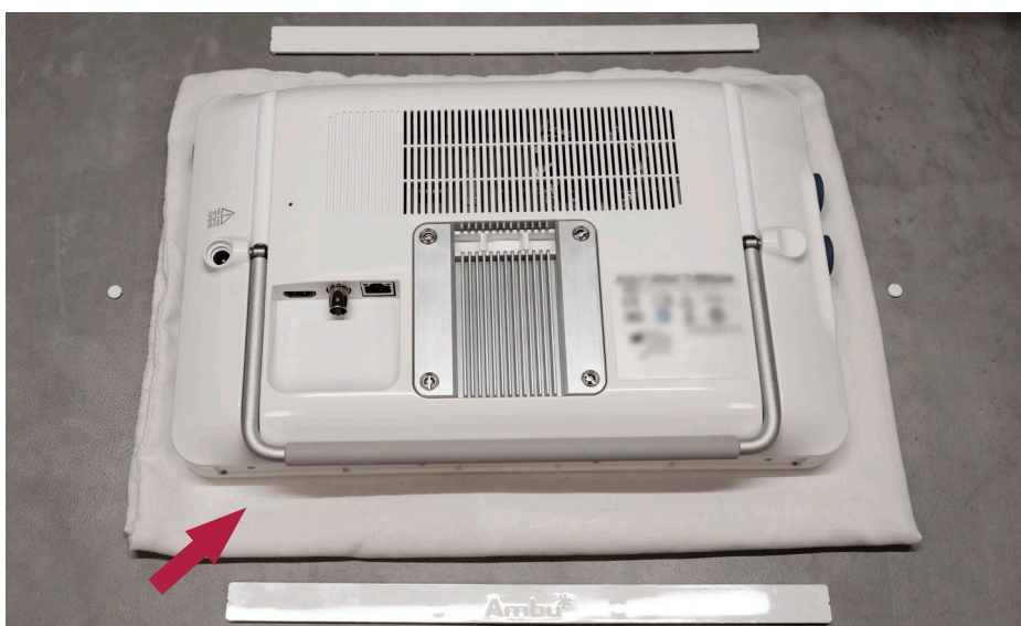
Kuva 8 Aseta näyttöyksikkö näyttö alaspäin
