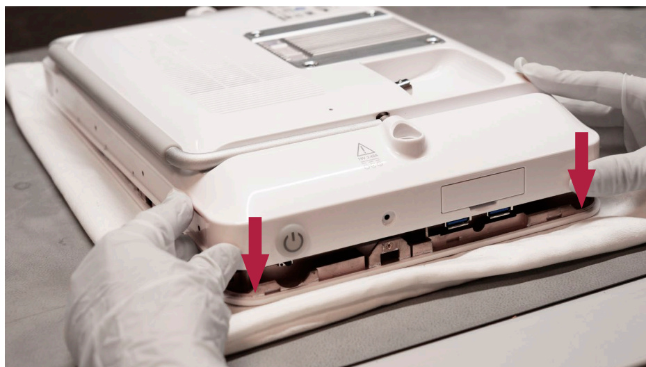
Obrázek č. 31 Nasazení zadního krytu zpět – pokračování
