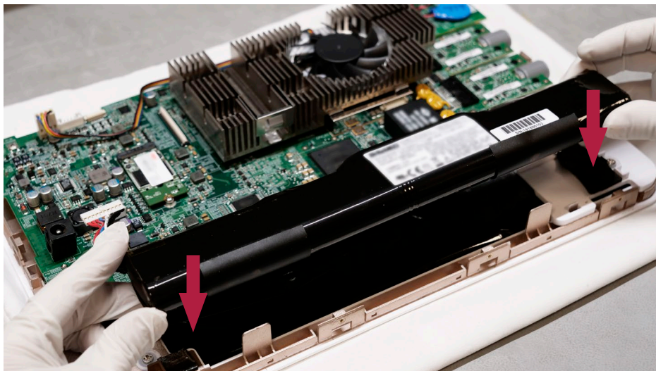
図15 粘着テープを下に向けて新しいバッテリーを配置する
