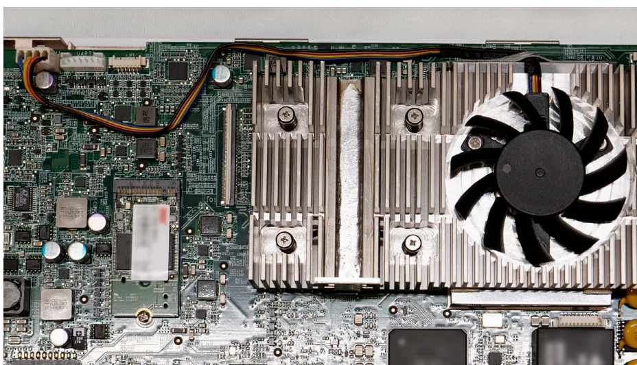
Obrázek č. 25 Instalace nového ventilátoru
