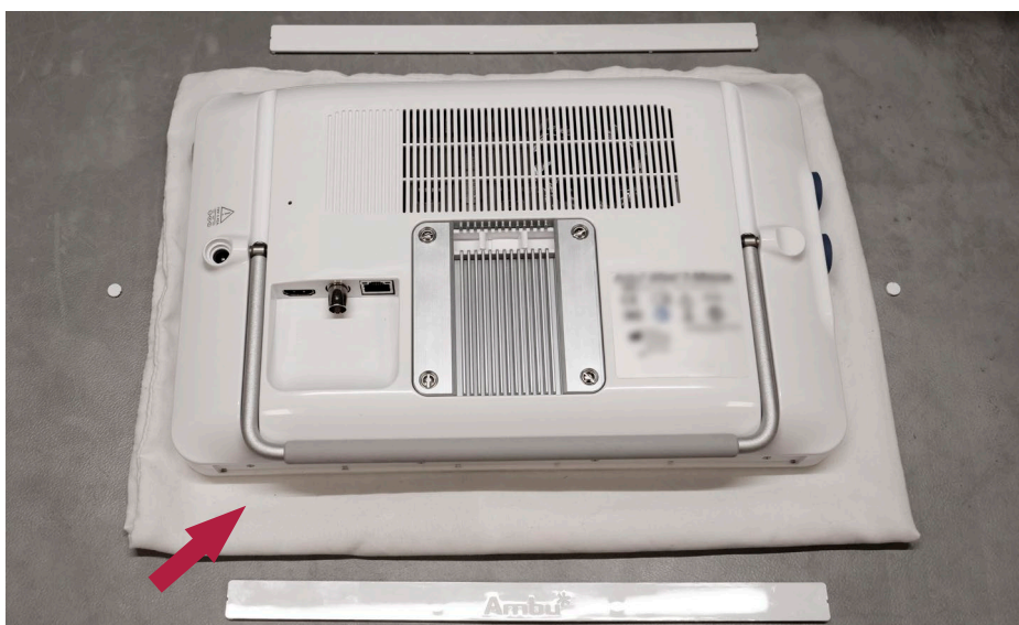
Slika 8 – postavljanje jedinice za prikaz okrenute prema dolje
