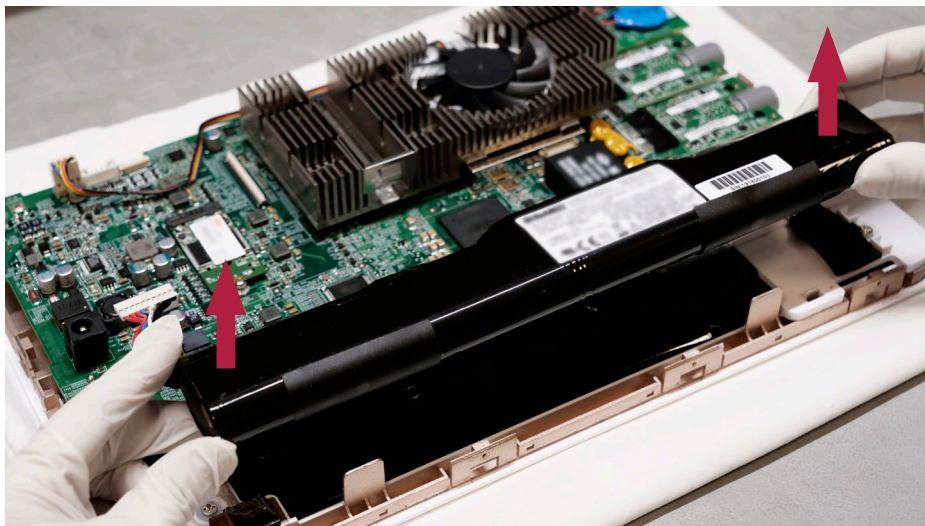
Figura 14 Retirar a bateria
