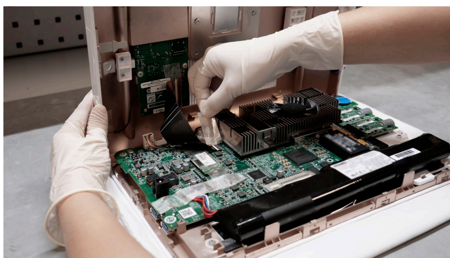
Figura 10 Deschideți carcasa dorsală cu atenție și îndepărtați banda adezivă acolo unde este necesar
