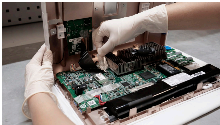
10. ábra: Óvatosan nyissa fel a hátsó burkolatot, és szükség esetén távolítsa el a ragasztószalagot
