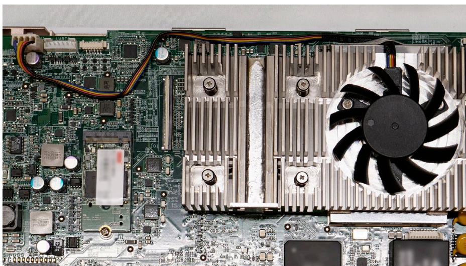
Joonis 25. Paigaldage ventilaator
