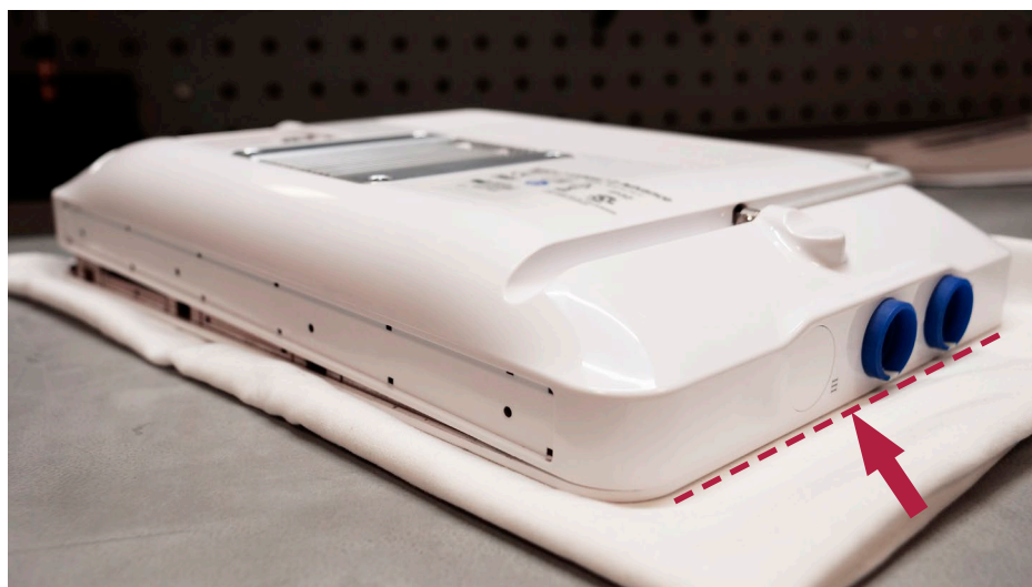
Obrázek č. 30 Nasazování zadního krytu zpět – začněte stranou s barevnými kroužky
