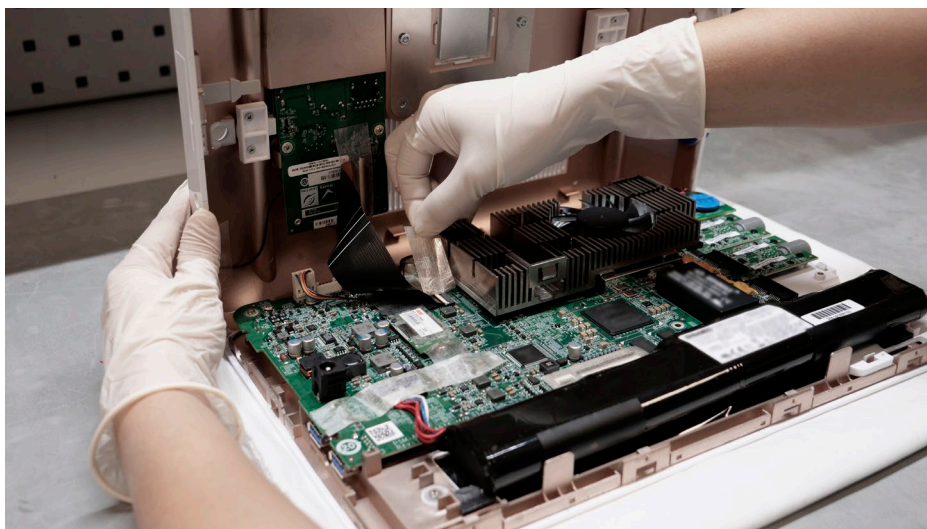
Obrázek č. 10 Odklopení zadního krytu a odstranění lepicí pásky
