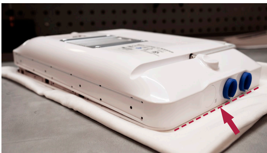
Joonis 30. Asetage korpuse tagakülj tagasi, alustades värvirõngastega küljest
