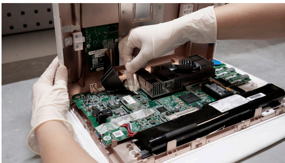
Slika 10 – oprezno otvorite stražnje kućište i po potrebi uklonite ljepljivu traku
