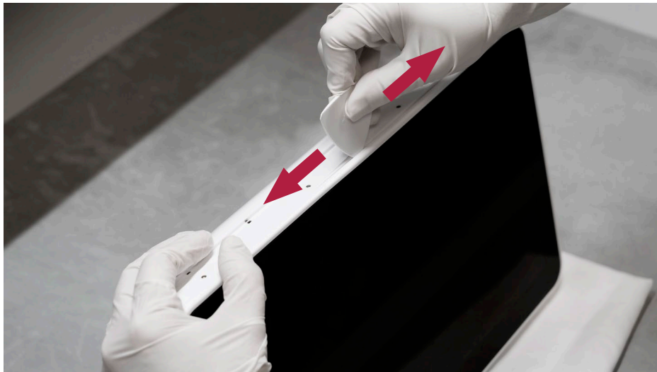
Figura 7 Rilascio dell'alloggiamento posteriore con lo strumento a forma di plettro
