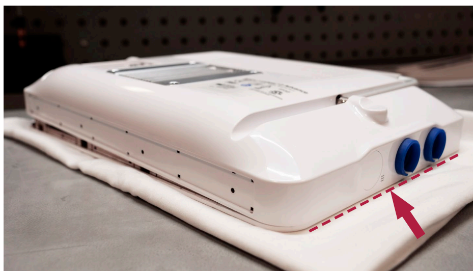
図 30 カラーリングのある側から始めて、背面ケースを配置する
