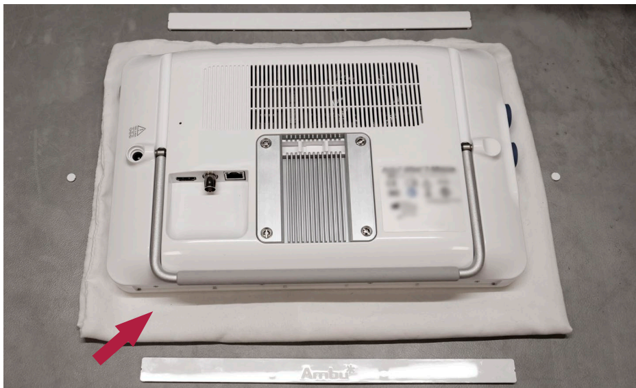
Abbildung 8 Die Visualisierungseinheit wird mit der Rückseite nach oben abgelegt
