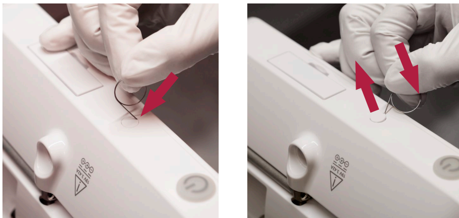
Slika 5 – uklanjanje pokrova za vijak
