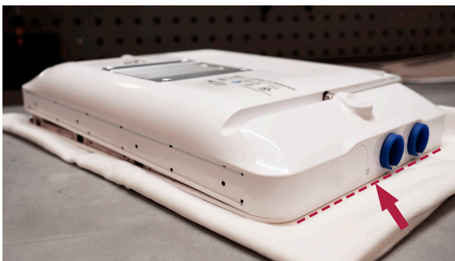
Obrázok 30 Umiestnite zadné puzdro, pričom začnite z bočnej strany s farebnými krúžkami
