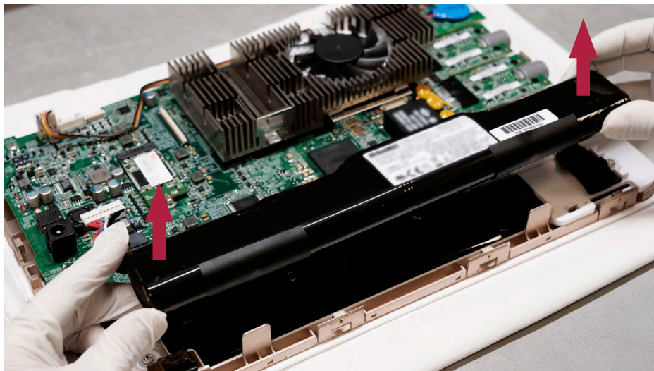
Illustration 14 : Retrait de la batterie
