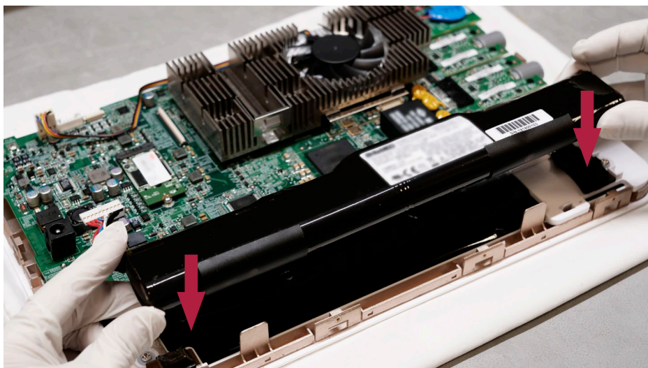
Obrázok 15 Vložte novú batériu tak, aby lepiaca páska smerovala nadol
