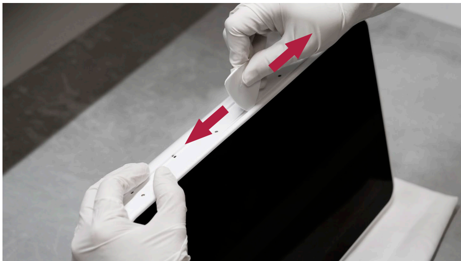
図7 プレクタラムツールを使用して背面ケースを解放する
