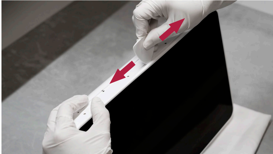
Abbildung 7 Lösen der rückseitigen Verkleidung mit dem Plektron-Werkzeug
