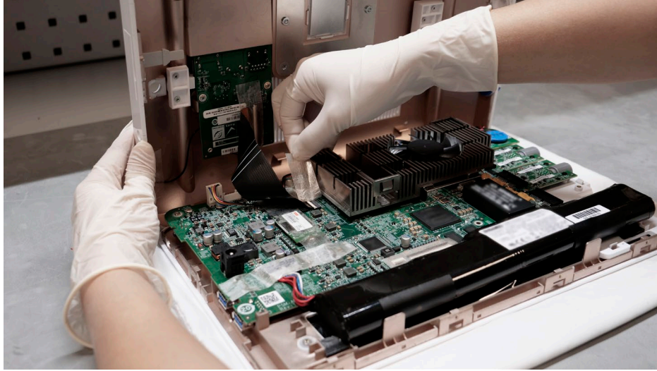
Şekil 10 Arka muhafazayı dikkatlice açın ve gerektiği takdirde yapışkan bantları sökün
