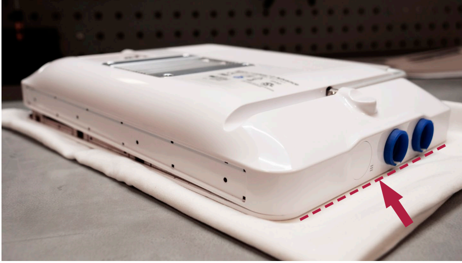
Şekil 30 Renkli halkaların olduğu kısımdan başlayarak arka muhafazayı takın
