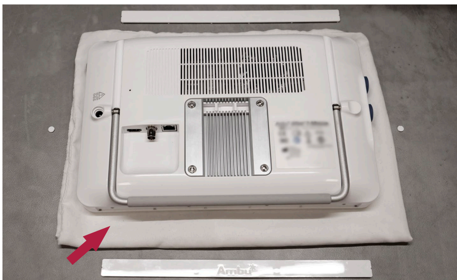
Фигура 8 Поставяне на дисплейния модул с лицевата страна надолу
