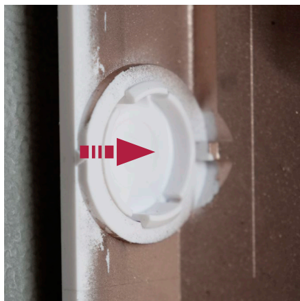
图 22 如果已经拆卸 VDI 板，必须安装连接器盖
