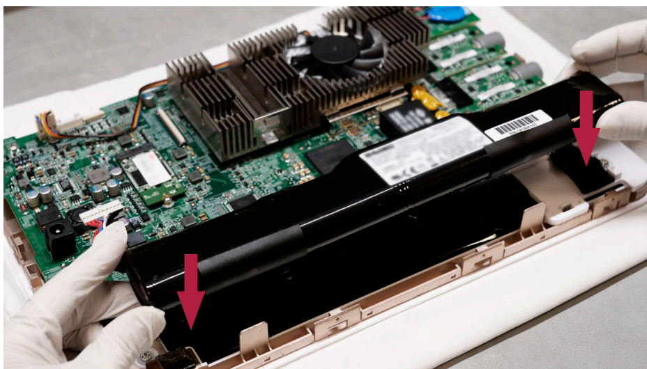
Obrázek č. 15 Vložení nové baterie s lepicí páskou směrem dolů
