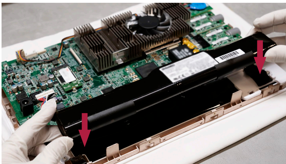
Εικόνα 15 Τοποθέτηση νέας μπαταρίας, με την αυτοκόλλητη ταινία στραμμένη προς τα κάτω
