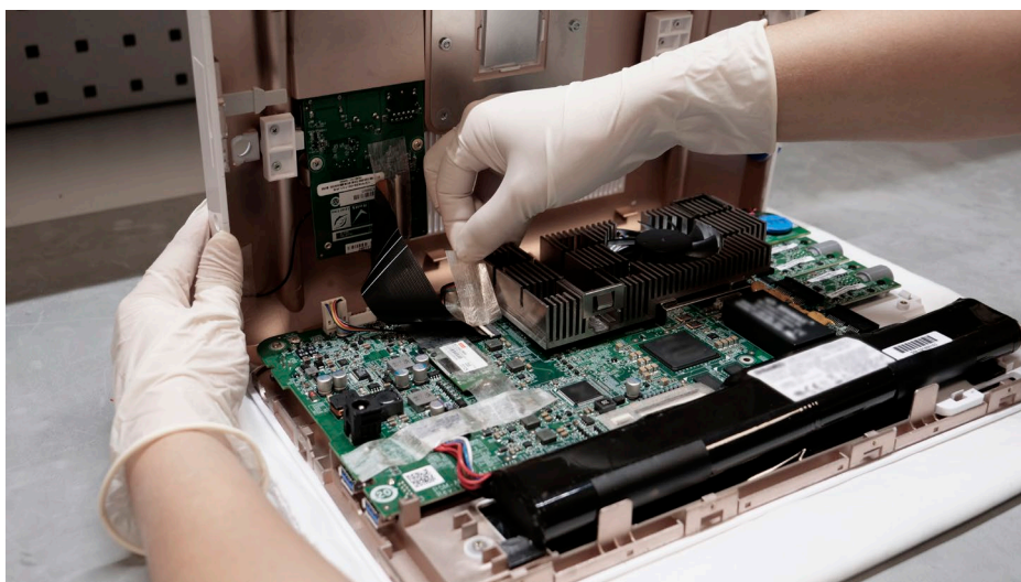
Εικόνα 10 Ανοίξτε το πίσω περίβλημα προσεκτικά και αφαιρέστε την αυτοκόλλητη ταινία, εάν χρειαστεί
