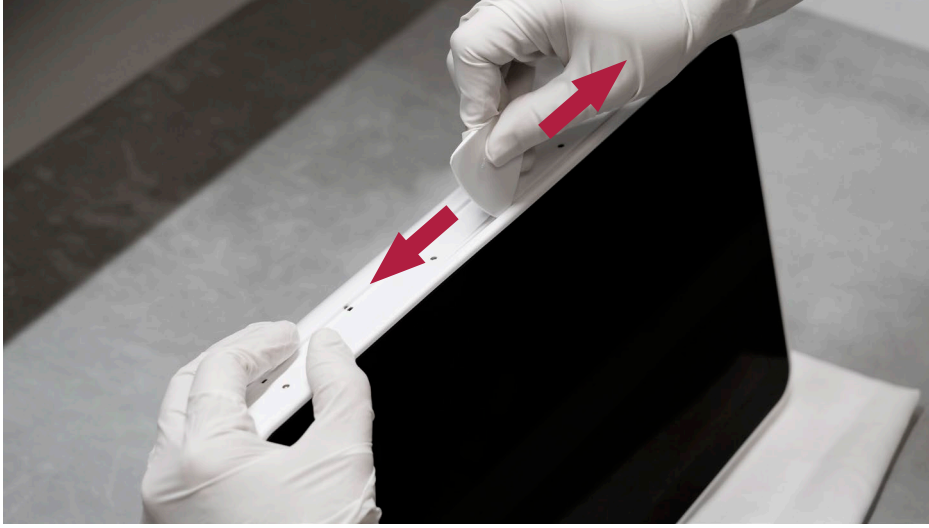
Şekil 7 Plektrum aracıyla arka muhafazayı sökme işlemi
