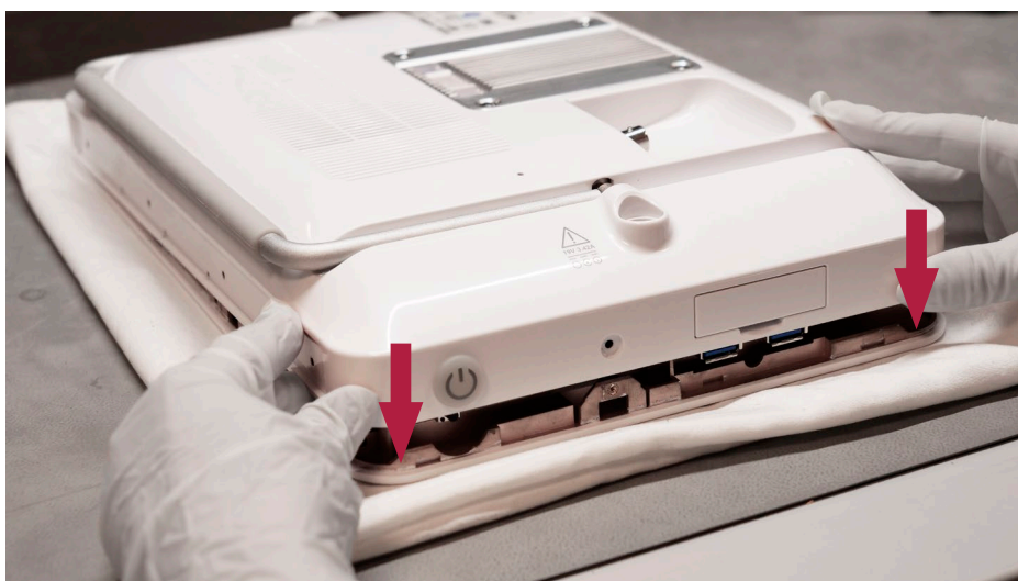
Рис. 31. Установка задней крышки корпуса, продолжение
