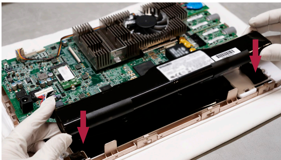
Figura 15 Așezați bateria nouă cu banda adezivă în partea de dedesubt
