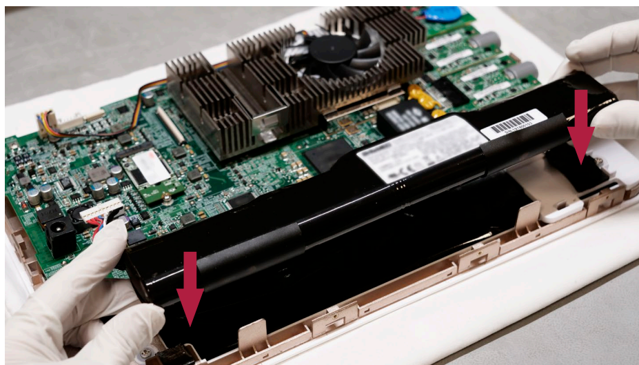
15. ábra: Helyezze le új akkumulátort úgy, hogy a ragasztószalag lefelé nézzen
