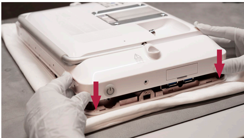
Abbildung 31 Anbringen der rückseitigen Verkleidung; Fortsetzung
