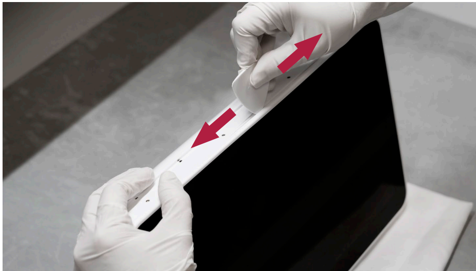
Εικόνα 7 Αποδέσμευση του πίσω περιβλήματος με την πένα ανοίγματος
