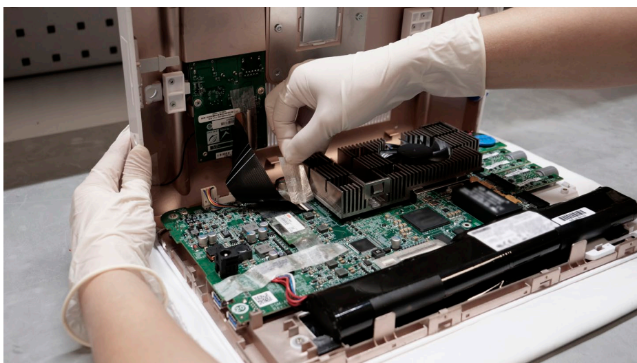
Afbeelding 10 De achterbehuizing voorzichtig openen en eventueel plakband zo nodig verwijderen
