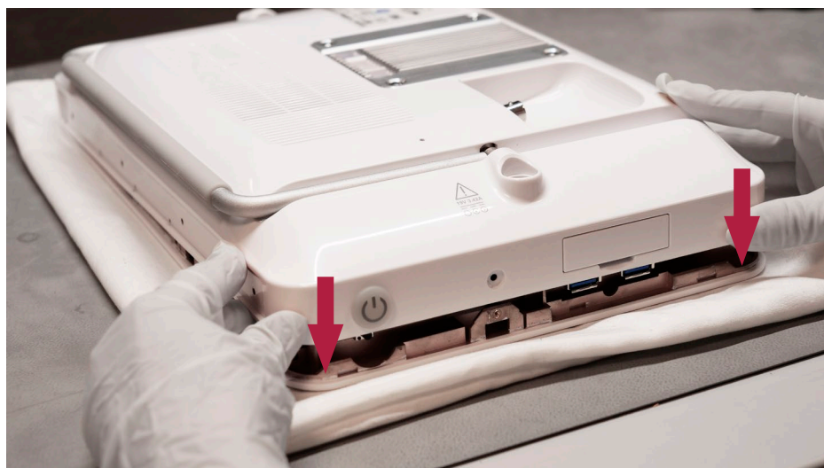
Figura 31 Colocar a caixa traseira, continuação
