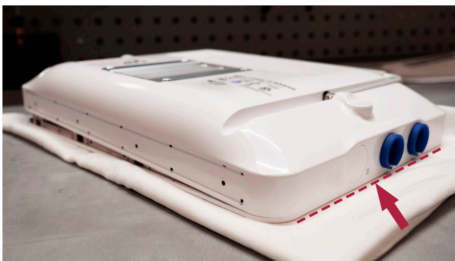
Slika 30: Namestitev zadnjega ohišja, najprej na strani z barvnimi obročki
