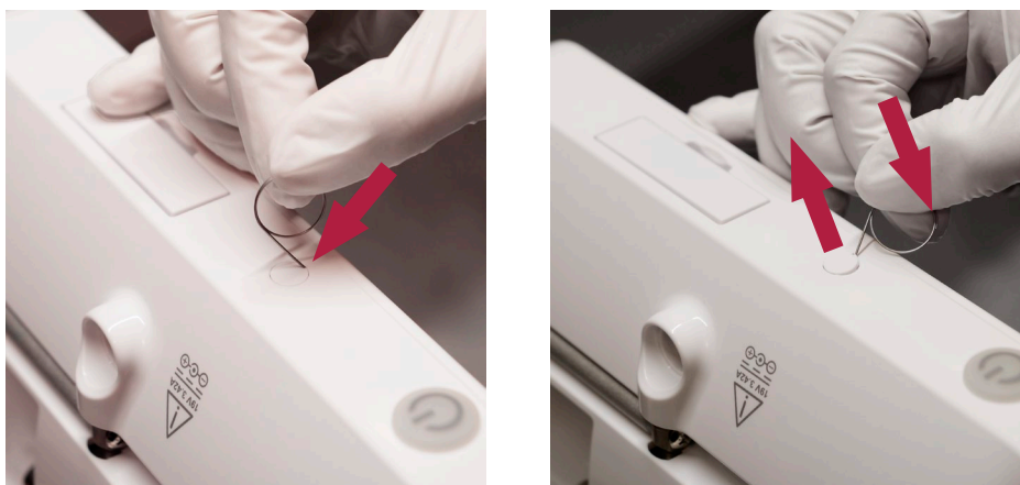
Фигура 5 Премахване на тапата за винта
