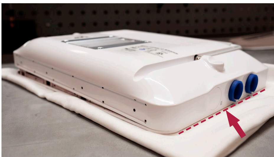
Kuva 30 Aseta takakotelo paikalleen aloittaen värirenkaiden puolelta
