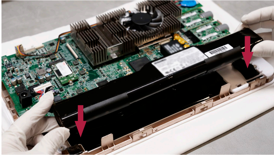
Şekil 15 Yapışkan bant aşağı bakacak şekilde yeni pili yerleştirin
