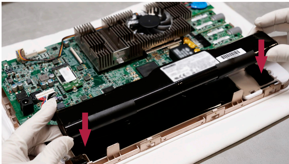
Abbildung 15 Eine neue Batterie wird mit dem Klebeband nach unten eingelegt
