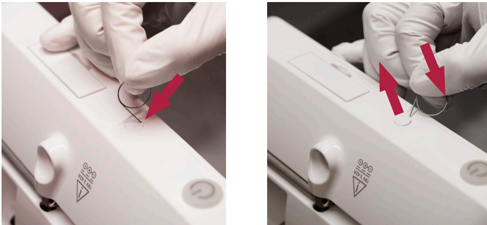
Εικόνα 5 Αφαίρεση του καλύμματος της βίδας
