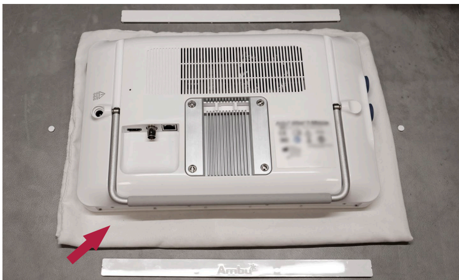
Afbeelding 8 De weergave-eenheid omlaag gericht plaatsen
