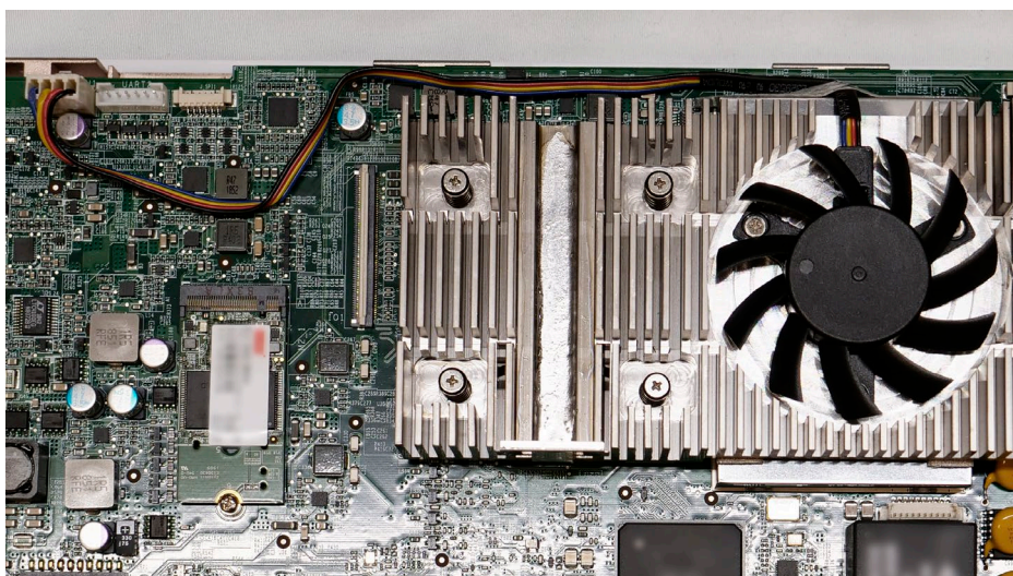
Figura 25 Instalar a ventoinha
