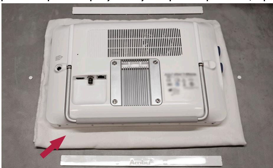
Рис. 8. Размещение устройства отображения экраном вниз
