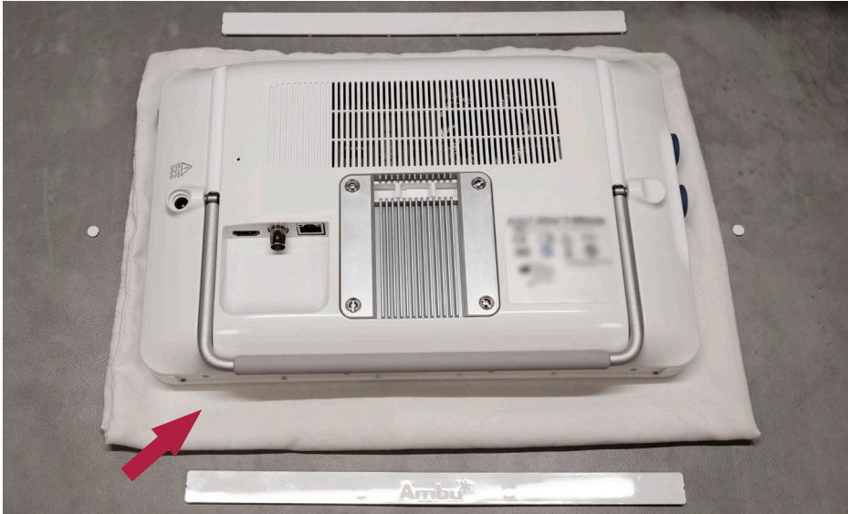
Şekil 8 Görüntüleme ünitesini aşağı bakacak şekilde koyun
