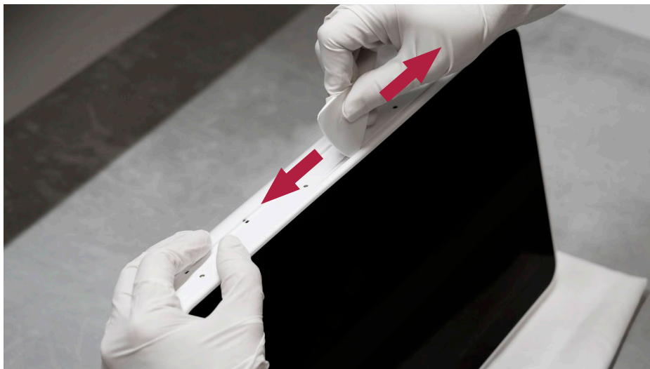
Illustration 7 : Retrait du boîtier arrière à l'aide du plectre
