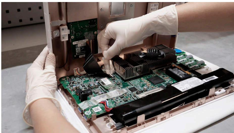
Illustration 10 : Ouvrez doucement le boîtier arrière et retirez le ruban adhésif le cas échéant
