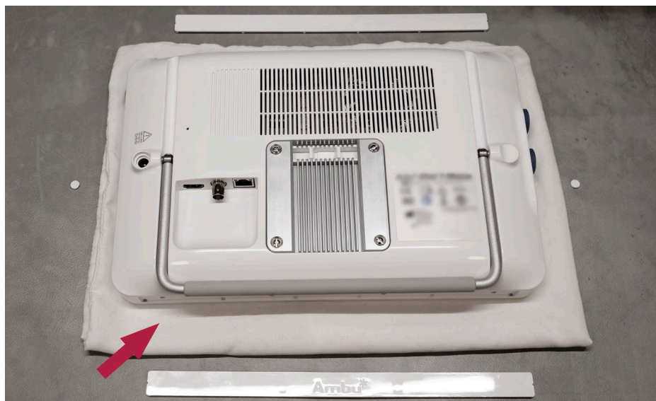
Obrázek č. 8 Položení zobrazovací jednotky čelem dolů
