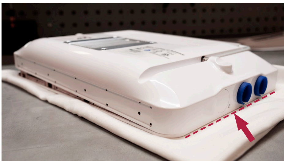
30. ábra: Helyezze fel a hátsó burkolatot, a színes gyűrűk oldalán kezdve
