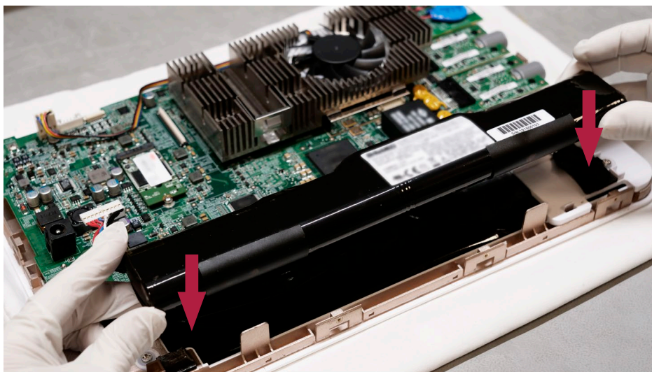
图 15 放置新电池时，胶带正面朝下
