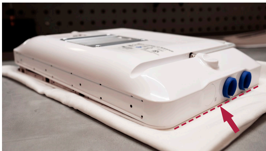
Figura 30 Colocación de la carcasa trasera, empezando por el lado con los anillos de color
