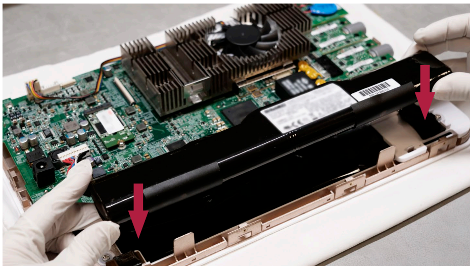
Figura 15 Colocación de una nueva batería, con la cinta adhesiva mirando hacia abajo
