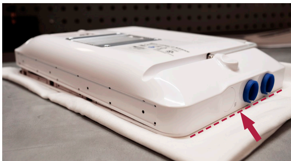
Εικόνα 30 Τοποθέτηση του πίσω περιβλήματος ξεκινώντας από το πλαϊνό μέρος με τους έγχρωμους δακτυλίους
