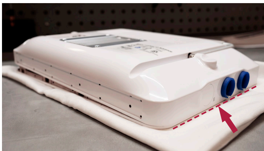
Bild 30 Sätt tillbaka höljets baksida, börja med sidan med färgringarna
