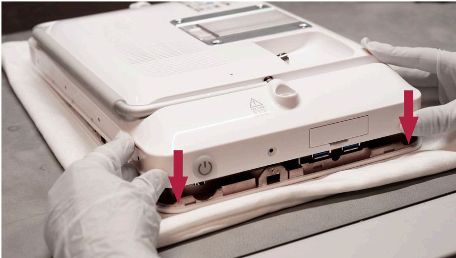
Şekil 31 Arka muhafazayı oturtma kısmının devamı
