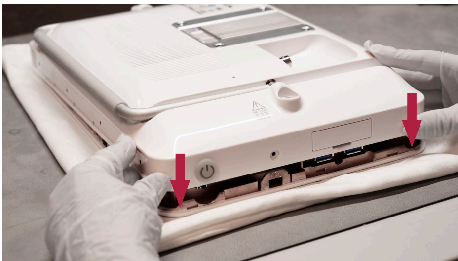
31. ábra: Helyezze fel a hátsó burkolatot – folytatás
