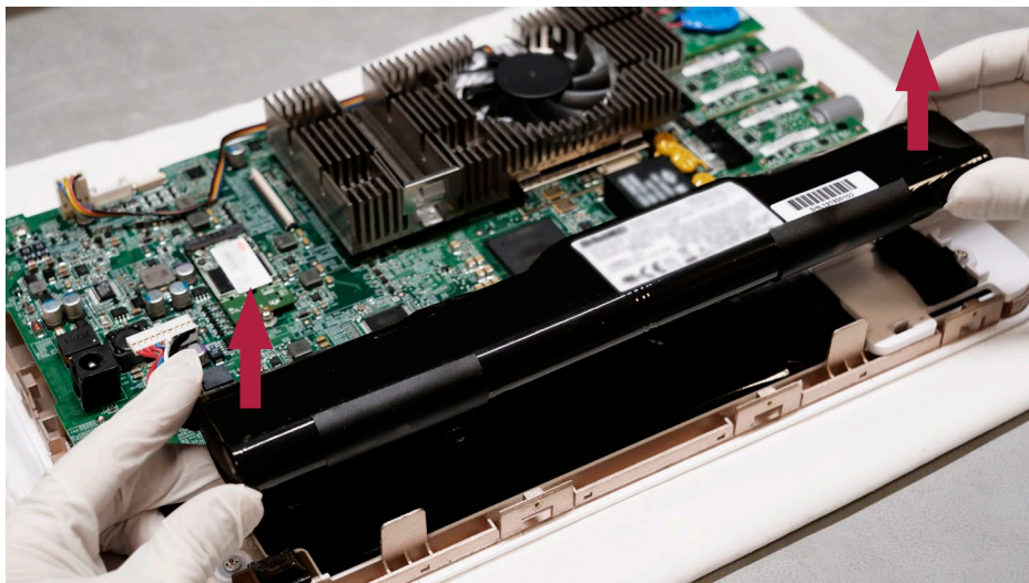
14. Attēls. Akumulatora izņemšana
