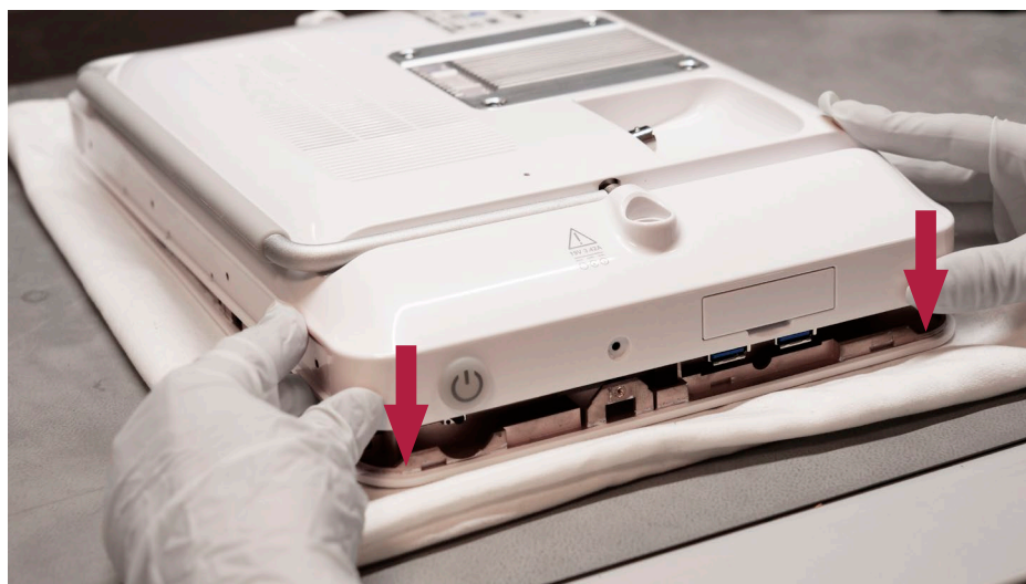
Afbeelding 31 De achterbehuizing plaatsen, vervolg
