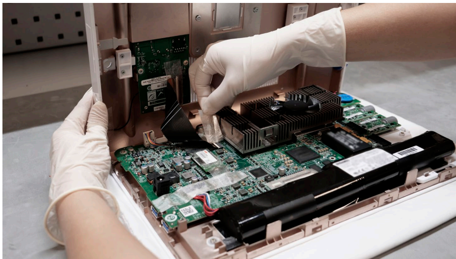
Kuva 10 Avaa takakotelo varovasti ja irrota teippiä tarpeen mukaan
