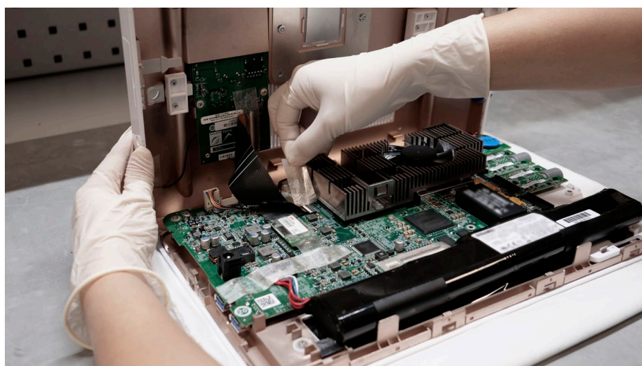
Рис. 10. Осторожно поднимите заднюю крышку, при необходимости снимите клейкую ленту
