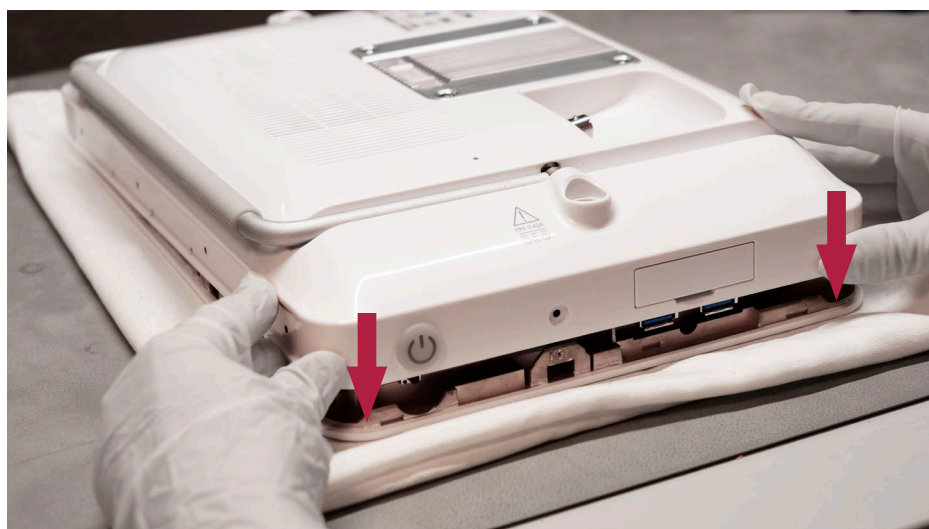
Εικόνα 31 Τοποθέτηση του πίσω περιβλήματος (συνεχίζεται)
