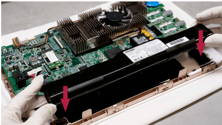
Kuva 15 Uuden akun asettaminen teippipuoli alaspäin
