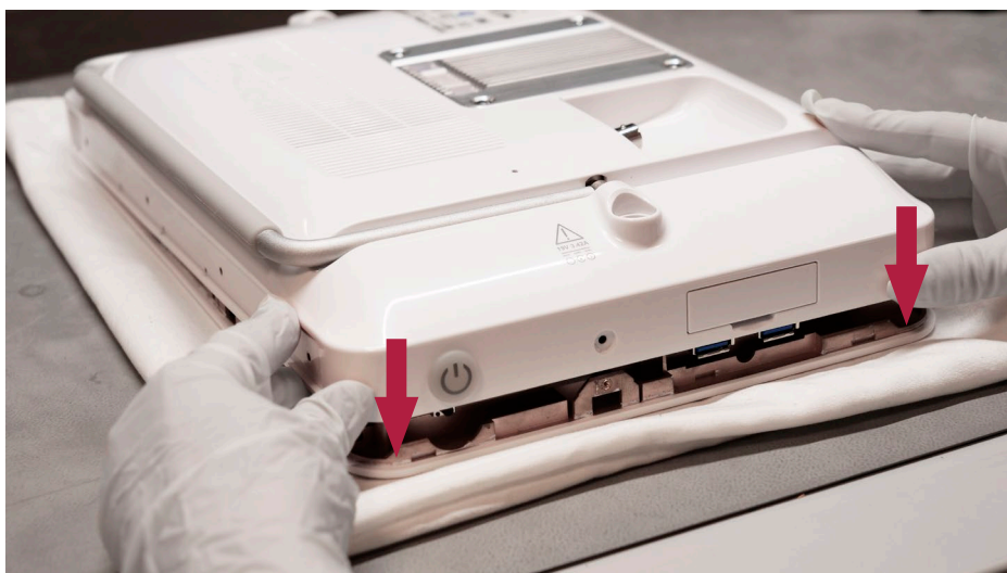
Figura 31 Montați carcasa dorsală, continuare
