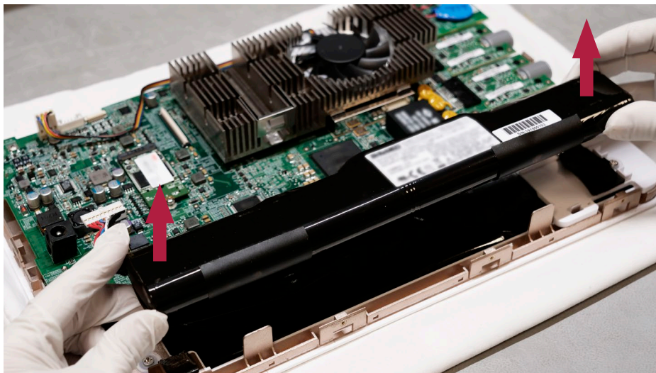
14. ábra: Vegye ki az akkumulátort
