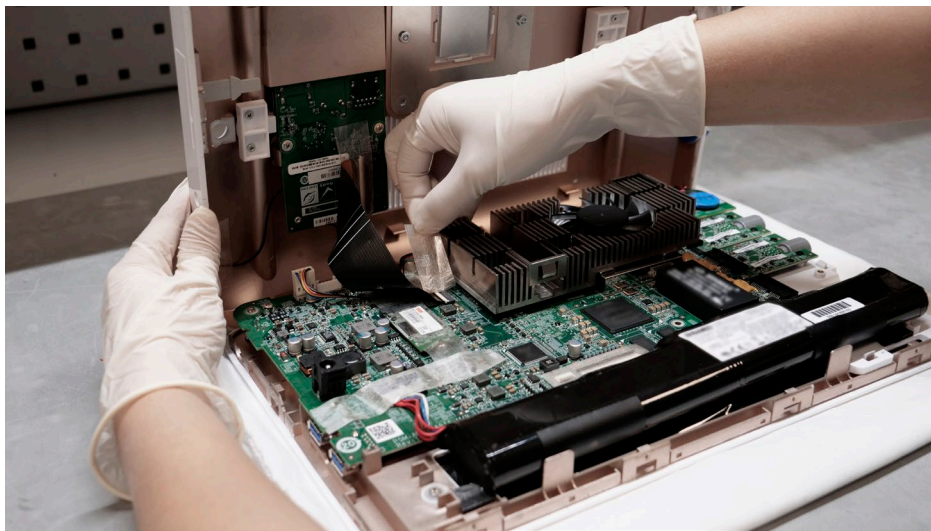
图 10 小心打开后壳，必要时拆除胶带
