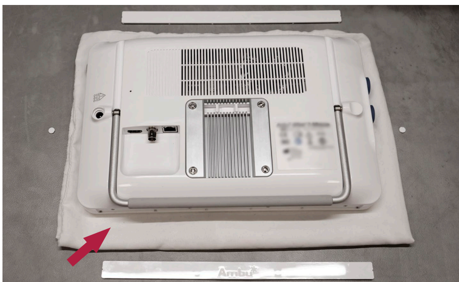
8. ábra: Helyezze le a megjelenítőegységet lefelé fordítva
