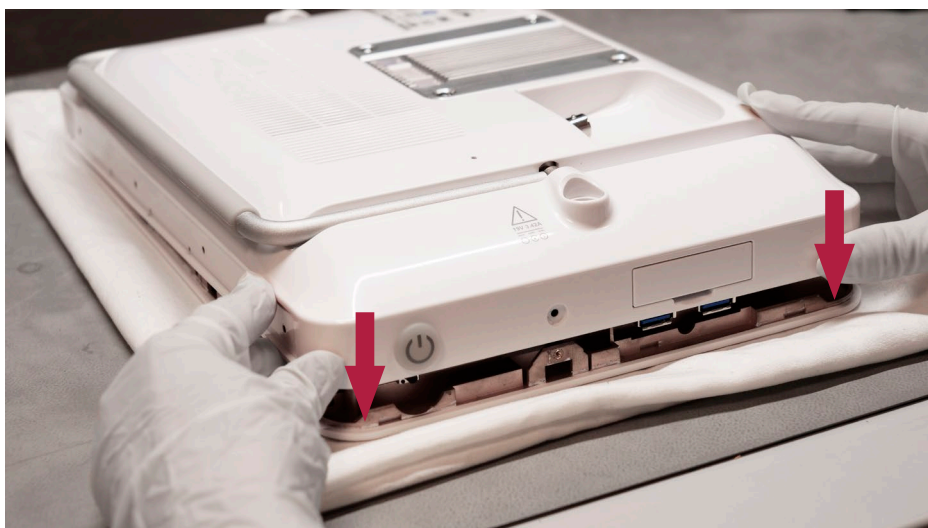
Slika 31 – postavljanje stražnjeg kućišta, nastavak
