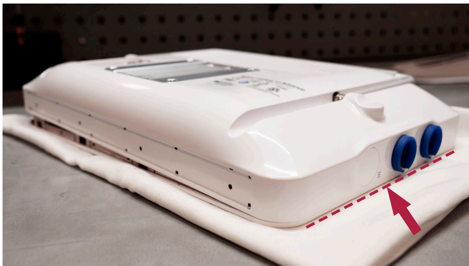
Фигура 30 Поставяне на задната част на корпуса, започвайки от страната с цветните пръстени
