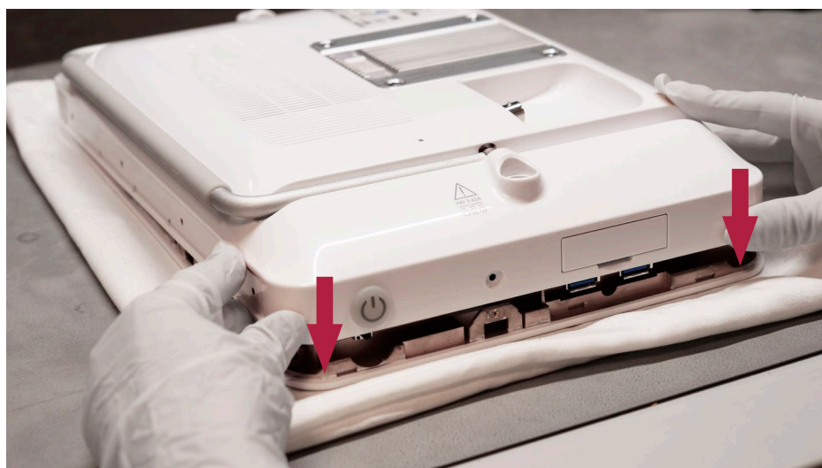
Figur 31 Sett på bakdekselet, forts.
