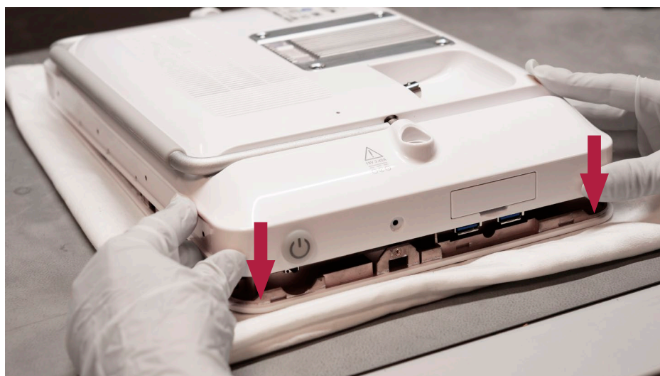
Illustration 31 : Mise en place du boîtier arrière (suite)
